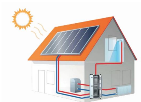
Slika 9.6: Na levi strani prikaz ogrevanja in priprava tople sanitarne vode v kombinaciji s sončnimi kolektorji, ter desno prikaz toplozračnih sončnih kolektorjev.
